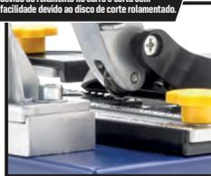
Barra única tipo viga I facilita a passagem do carro de corte e garante maior durabilidade.
