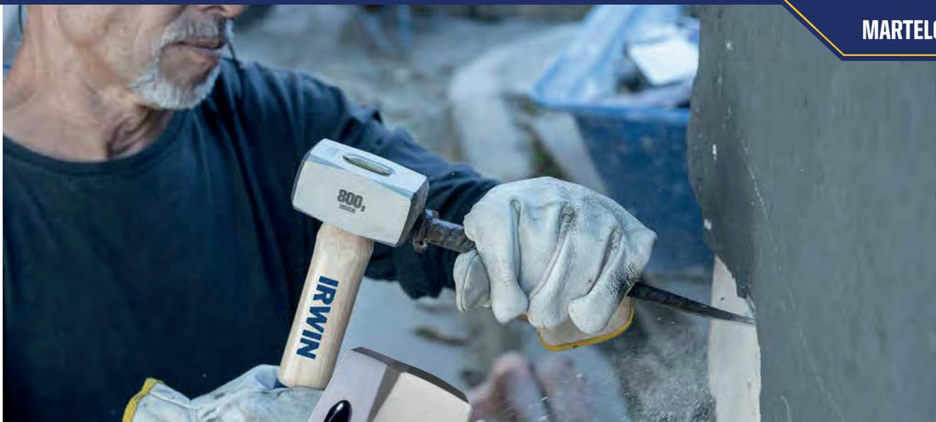
Cabeça em aço carbono, forjado e com batentes polidos.
